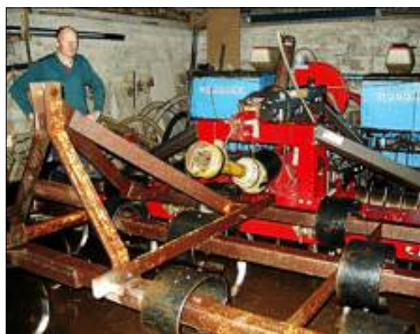
Alain Guéguen et son « gratteur de terre ». Selon cet agriculteur, le taux de pénétration de la pluie dans la terre après le passage de son engin est multiplié par trois.
